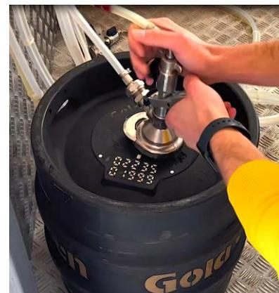
4. Schritt: Hebel nach unten bewegen und Zufluss öffnen
