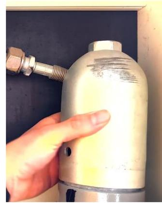
Den Schlauch der linken Kartusche abschrauben und beiseite legen. Die Abdeckung der rechten Kartusche abschrauben und auf die linke Kartusche aufsetzen.
