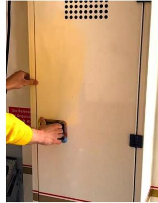
Den roten Hebel von quer auf längs stellen und somit schließen.
