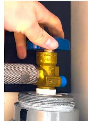
Den Schlauch auf die rechte Kartusche schrauben. Die Kartusche ganz aufdrehen und im Anschluss eine dreiviertel Umdrehung zurück.
