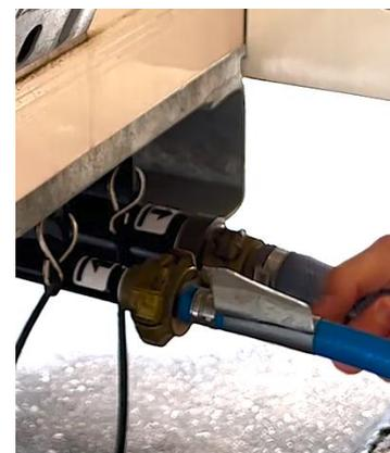
Der dünne Schlauch ist die Zuwasser Leitung und muss auf den vorderen Stutzen, der dicke Schlauch ist die Abwasser Leitung und muss auf den hinteren Stutzen aufgesetzt werden. Der Schlauch wird durch eine Drehbewegung auf dem Anschluss fixiert.
