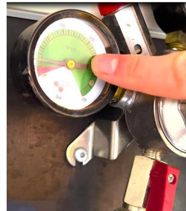
Die linke Kartusche ganz aufdrehen und im Anschluss eine viertel Umdrehung zurückdrehen. Der Zeiger des Druckminderer muss im grünen Bereich liegen.
