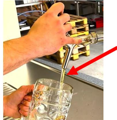
Hebel nach vorne ziehen, um Wasser und Schaum abzulassen. Ablassen bis ein klarer Strahl, wie im rechten Bild zu sehen, herauskommt.
